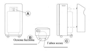
Для того чтобы установить задний кожух следуйте шагам A, B,C:
